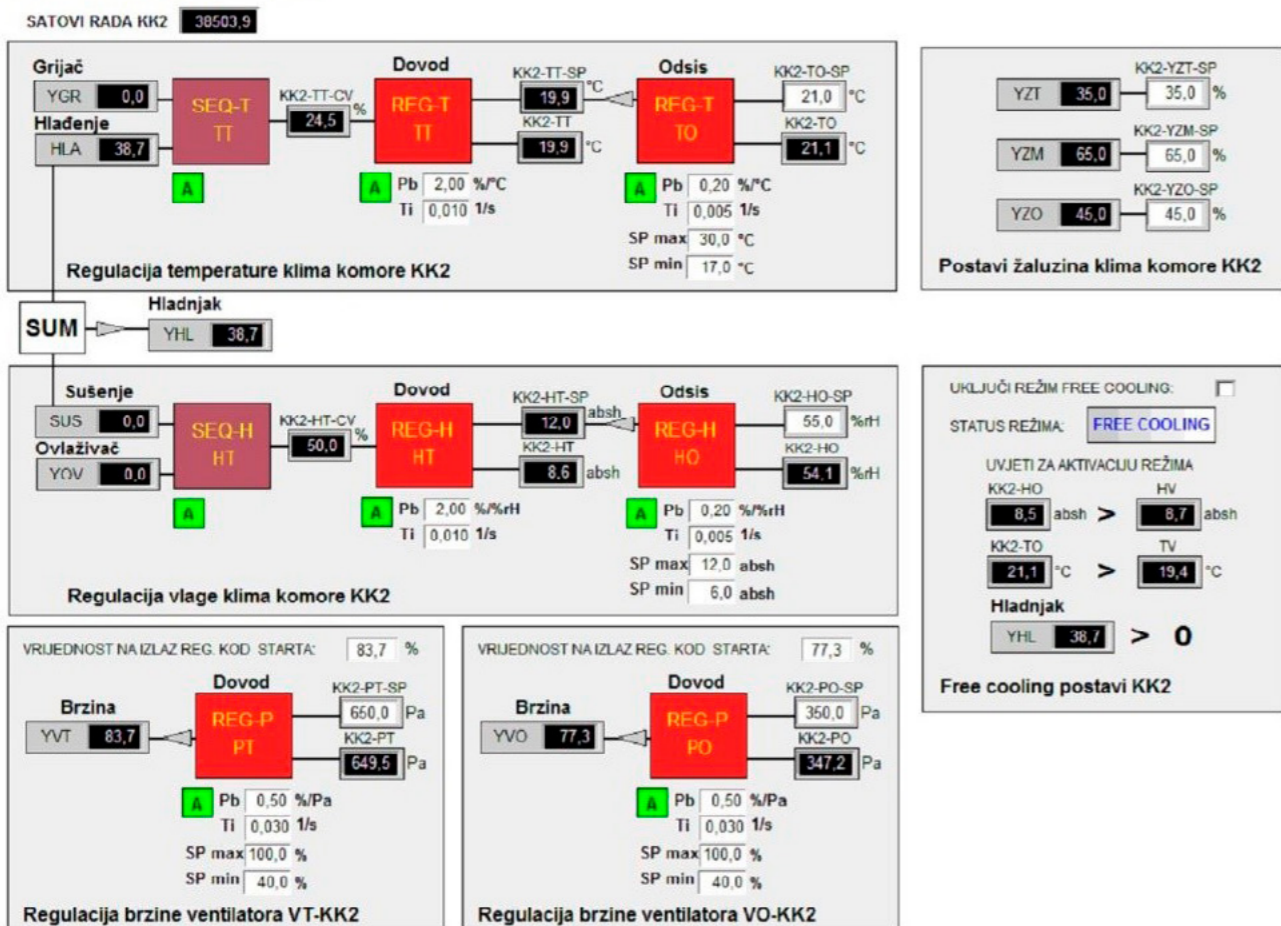
Figure 2. Overview of setting parameters of the air conditioning chamber Slika 2. Prikaz postavnih parametara klimakomore
